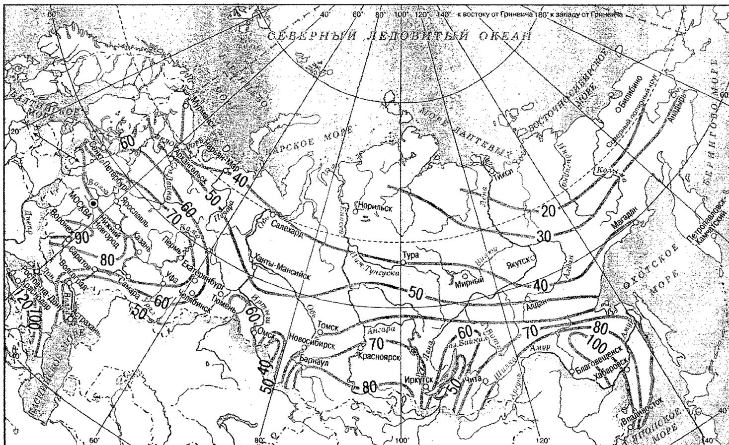
Рисунок Б.1. Значения величин интенсивности дождя  $Q_{20}$
